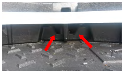
Scatola di bloccaggio delle barre elastiche.
