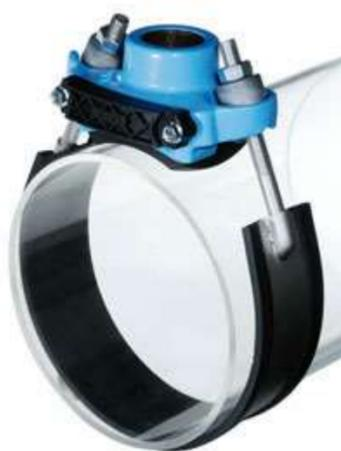
Corpo universale per realizzazione di prese d'utenza su tubazioni in materiale metallico e in cemento amianto. Un singolo corpo con uscita filettata per differenti diametri di condotta. Staffa in acciaio inossidabile e guaina gomma per un migliore posizionamento e facilmente montabile con un solo operatore.
